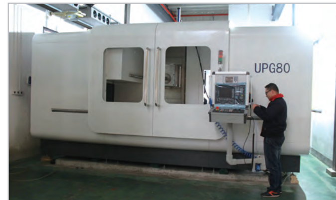
▲ 大口径光学非球面超精密磨削机床
