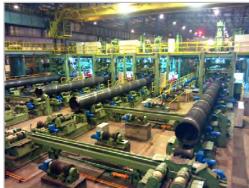
▲ 大口径厚壁油气钢管优质高效预精焊成套装备
