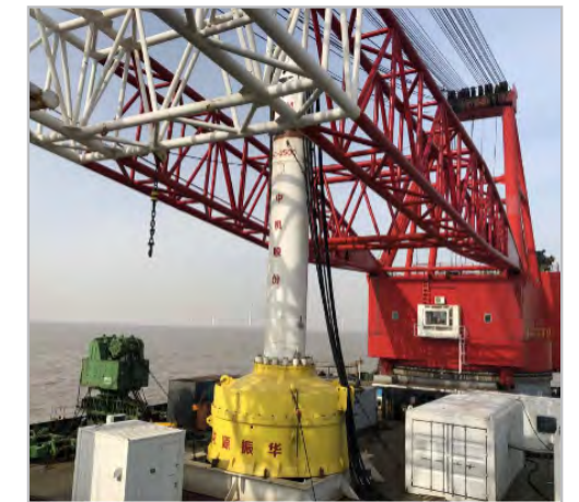
▲ 大型程控双作用水下液压打桩锤
