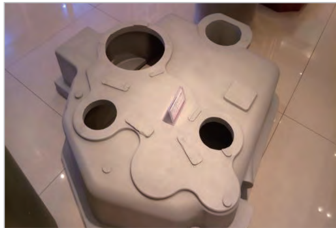
▲ V 法反重力浇注工艺及其生产的箱体铝合金铸件
